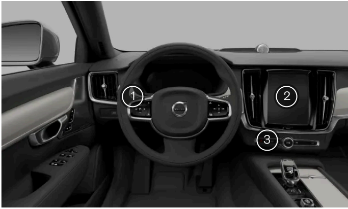
Lage der Bedienelemente für die Außenbeleuchtung
