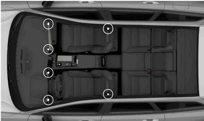
Lage der verstellbaren Lüftungsdüsen
