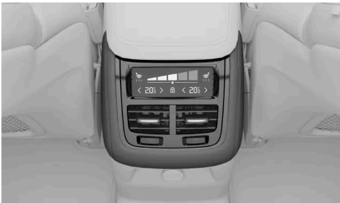
Bedienelemente der Klimaanlage an der Tunnelkonsole
