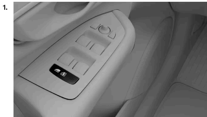
Position der Kindersicherungstaste in der Türverkleidung
