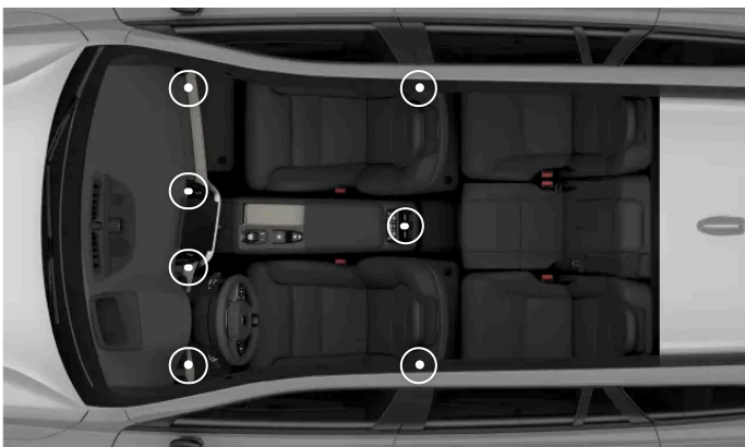
Lage der verstellbaren Lüftungsdüsen
