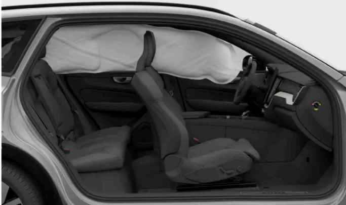
Auf einer Seite des Fahrzeugs ausgelöster Kopf-/Schulterairbag.
