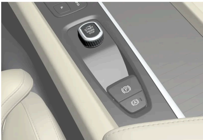
Startschalter auf der Tunnelkonsole.
