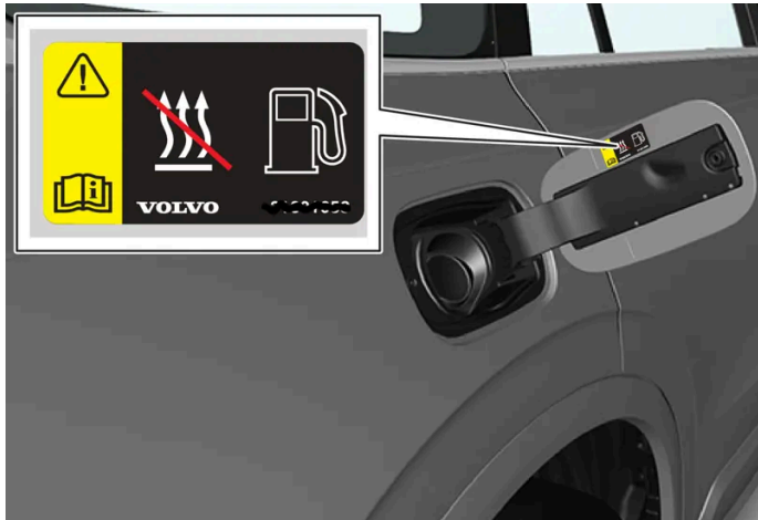
Warnaufkleber auf der Kraftstofftankklappe.
