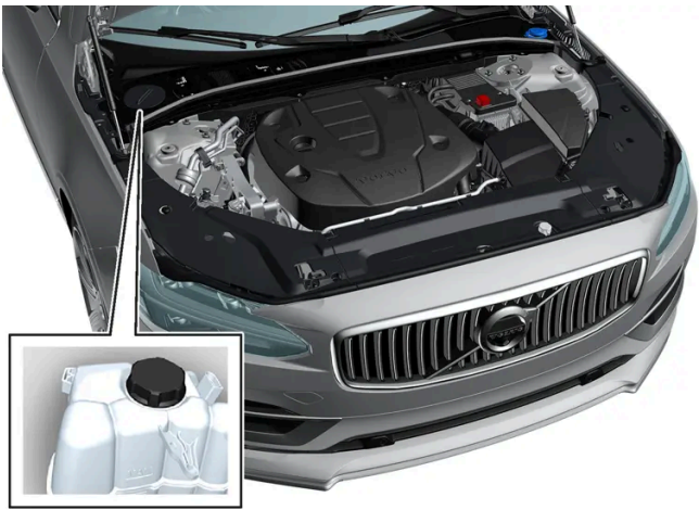
Ausgleichsbehälter der Kühlanlage, Linkslenker.
