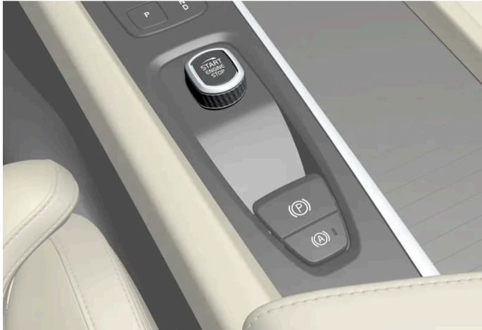
Startschalter auf der Tunnelkonsole.
