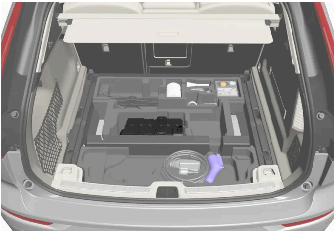
Die Startbatterie befindet sich im Kofferraum.
