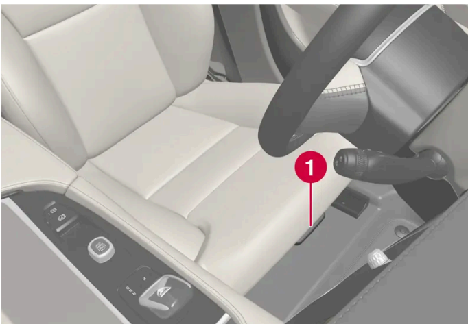
Schalter zur Längenverstellung des Sitzpolsters.
