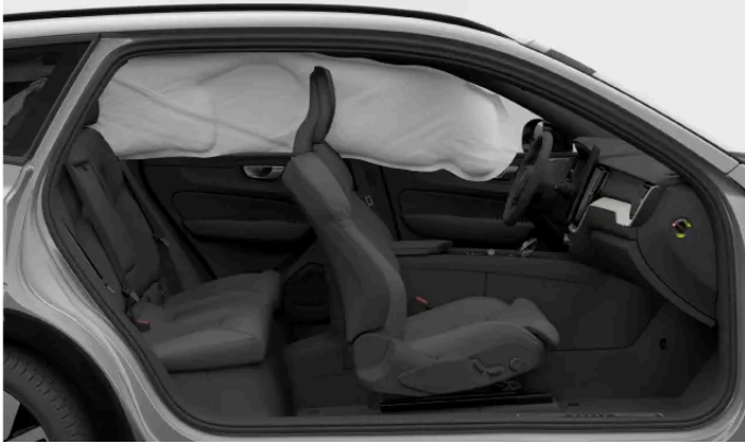
Auf einer Seite des Fahrzeugs ausgelöster Kopf-/Schulterairbag.
