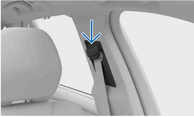
Oberer Verankerungspunkt des Sicherheitsgurts.
