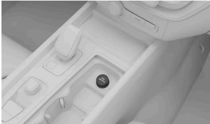
Die 12-V-Steckdose in der Tunnelkonsole
