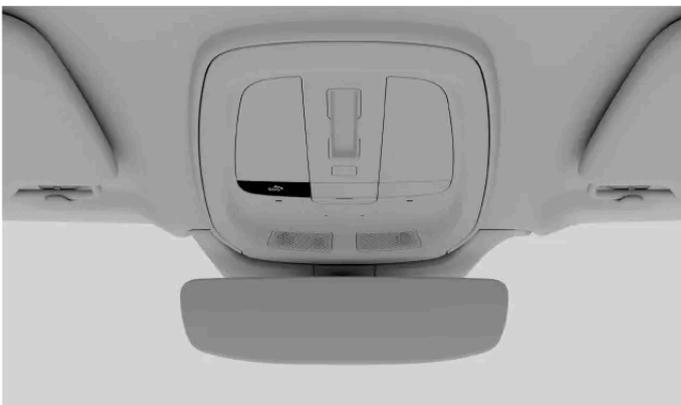
Die SOS-Taste befindet sich in der Deckenkonsole auf der linken Seite der Dachkonsole.
