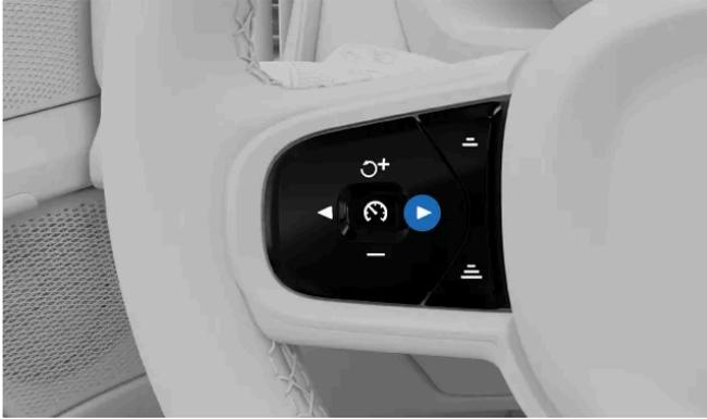
Drücken Sie die Umschalttaste ► am Lenkrad.
