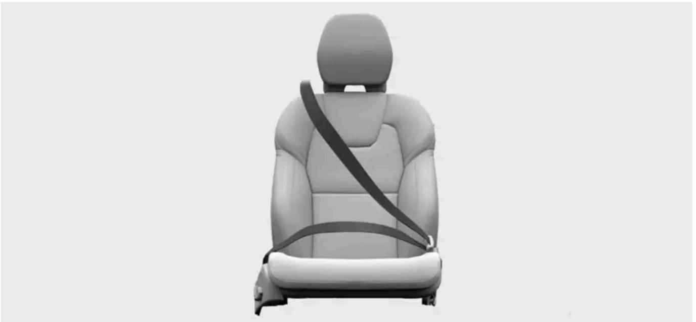
Unter bestimmten Bedingungen wird der Sicherheitsgurt automatisch arretiert, um die Person auf dem Sitz zu schützen. Dies kann z. B. der Fall sein, wenn der Gurt plötzlich und kraftvoll herausgezogen, das Fahrzeug aggressiv gefahren oder gerade ein steiler Hang befahren wird.
