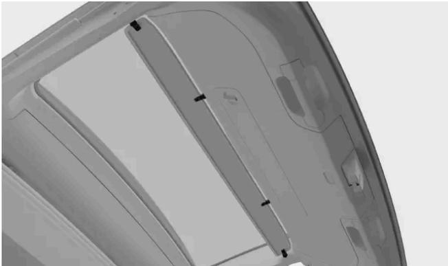
Führen Sie einen Stift am Kofferraumdeckelsichtschild in die Halterung auf einer Seite am Kofferraumdeckel ein.
