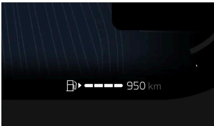
Ihre Reichweite ist in erster Linie von der verbleibenden Kraftstoffmenge in Ihrem Fahrzeugtank und Ihrer Fahrweise abhängig, wird aber auch durch externe Faktoren beeinflusst. Die Tankanzeige und die berechnete Reichweite werden auf dem Fahrerdisplay angezeigt.
