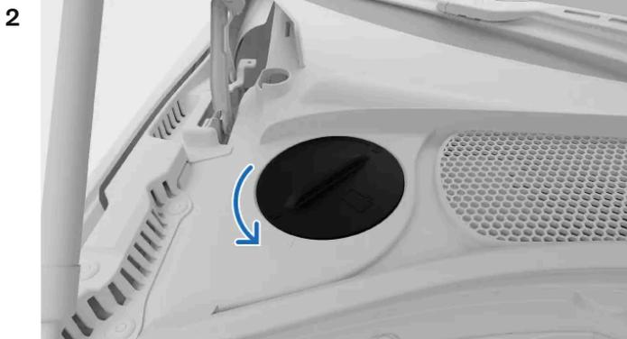
Öffnen Sie die Klappe in der linken oberen Ecke des Motorraums, um an den Kühlmittelbehälter zu gelangen.
