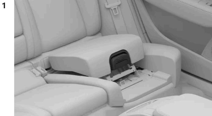
Ziehen Sie am Griff, der sich vorn an der Sitzerrhöhung befindet, um die Arretierung aufzuheben.
