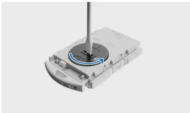
Drehen Sie die Batterieabdeckung mit einem geeigneten Werkzeug, z. B. mit einem Schraubendreher oder einer Münze, gegen den Uhrzeigersinn, um sie zu lösen.
