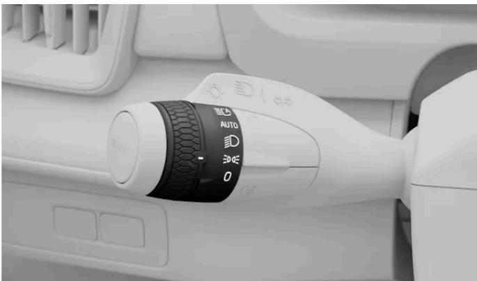
Symbol der Positionsleuchten am Drehring des linken Lenkradhebels
