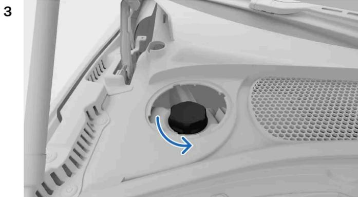
Schrauben Sie den Deckel des Kühlmittelbehälters ab.
