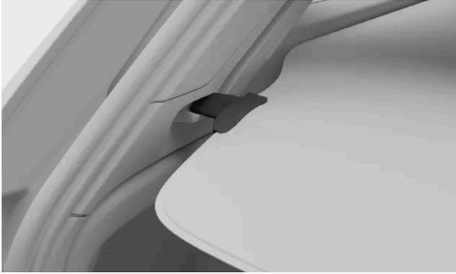
Führen Sie die Enden der Laderaumabdeckung in den Rillen in die eingerastete Position.
