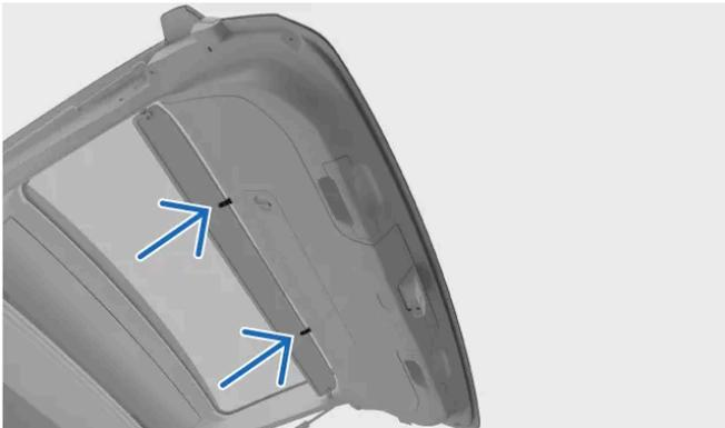
Drücken Sie die beiden Clips an der Längsseite des Kofferraumdeckelsichtschutzes nach oben, bis sie am Kofferraumdeckel einrasten.
