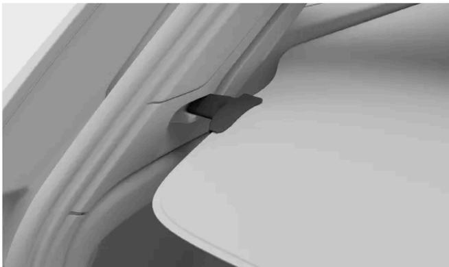
Heben Sie das Ende der Laderaumabdeckung an und ziehen Sie am Griff, um die Abdeckung freizugeben. Jetzt kann die Laderaumabdeckung eingezogen werden.
