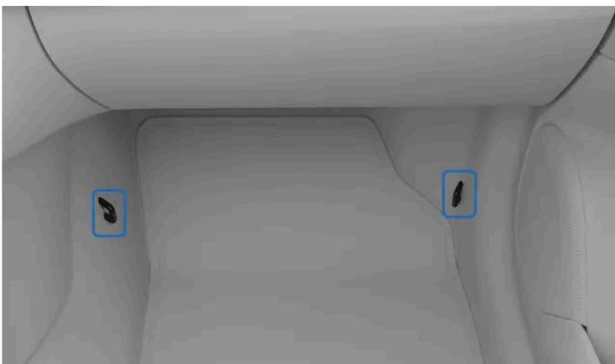
Die unteren Verankerungspunkte für den Beifahrersitz befinden sich an den Seiten des Beifahrerfußraums.
