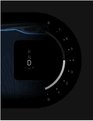
Der ausgewählte Fahrmodus wird im Fahrerdisplay<sup>[1]</sup> über der gewählten Schaltstellung angezeigt.
