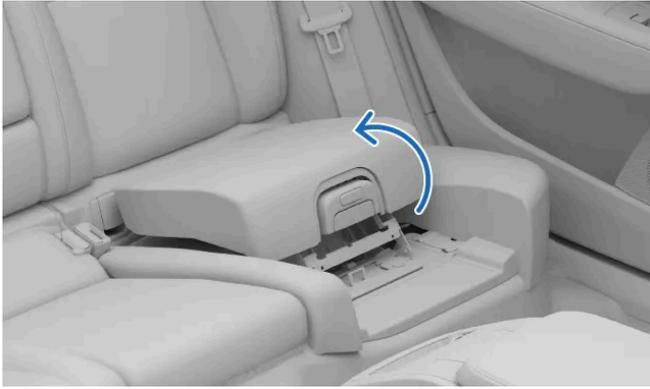
Heben Sie die Sitzerrhöhung vorn an und schieben Sie sie nach hinten an die Rückenlehne.
