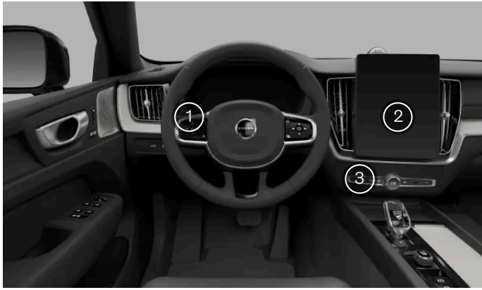
Lage der Bedienelemente für die Außenbeleuchtung
