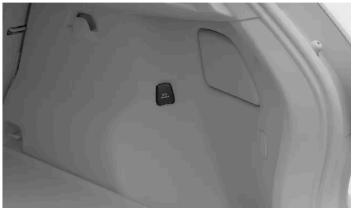
Die 12-V-Steckdose an der rechten Kofferraumwand
