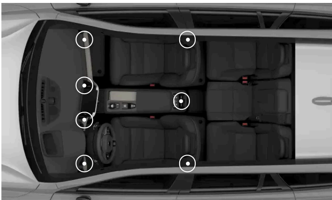
Lage der verstellbaren Lüftungsdüsen
