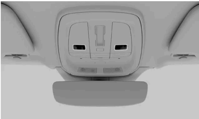
Die vorderen Leseleuchten an der Deckenkonsole
