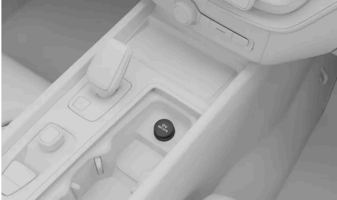
Die 12-V-Steckdose in der Tunnelkonsole
