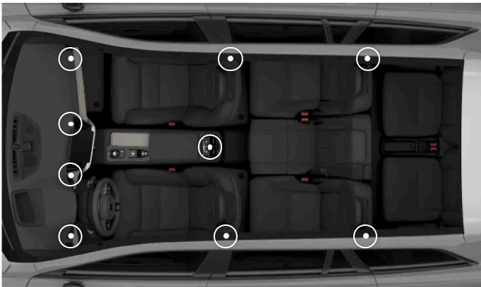
Lage der verstellbaren Lüftungsdüsen
