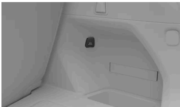
Die 12-V-Steckdose an der rechten Kofferraumwand
