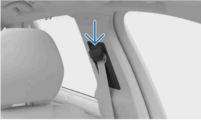
Oberer Verankerungspunkt des Sicherheitsgurts.
