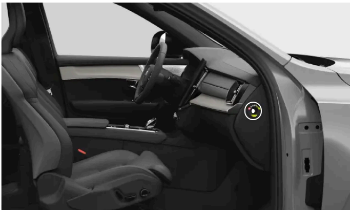
Lage des Beifahrerairbagschalters
