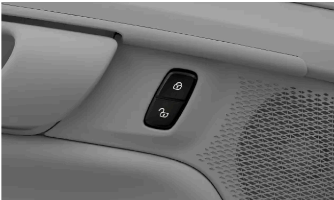
Zentralverriegelungstaste an der Vordertür
