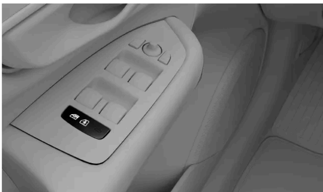
Position der Kindersicherungstaste in der Türverkleidung
