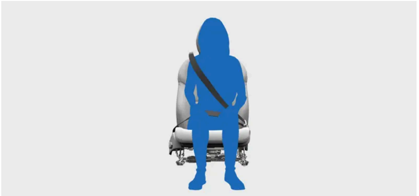
Richtig angelegter und eingestellter Sicherheitsgurt.
