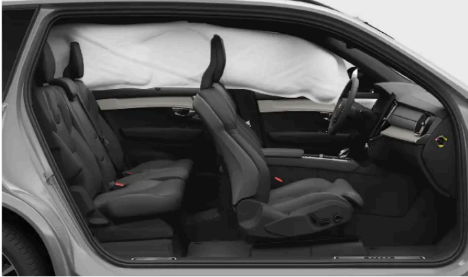
Auf einer Seite des Fahrzeugs ausgelöster Kopf-/Schulterairbag.
