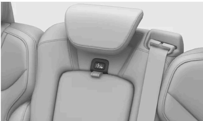
Verriegelungstaste an der mittleren Kopfstütze
