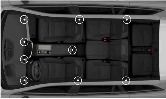
Lage der verstellbaren Lüftungsdüsen
