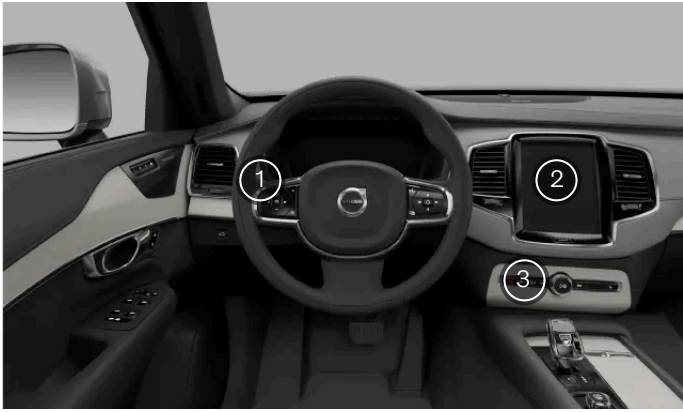
Lage der Bedienelemente für die Außenbeleuchtung
