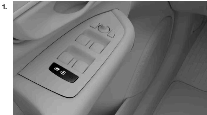
Position der Kindersicherungstaste in der Türverkleidung
