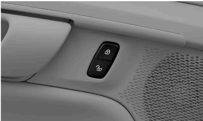
Zentralverriegelungstaste an der Vordertür
