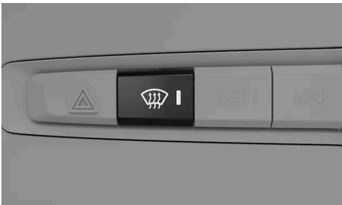
Enteisungstaste im Tastenfeld unter dem Center Display
