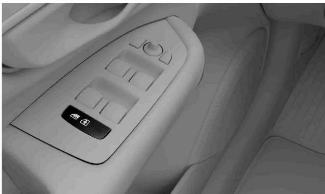
Position der Kindersicherungstaste in der Türverkleidung
