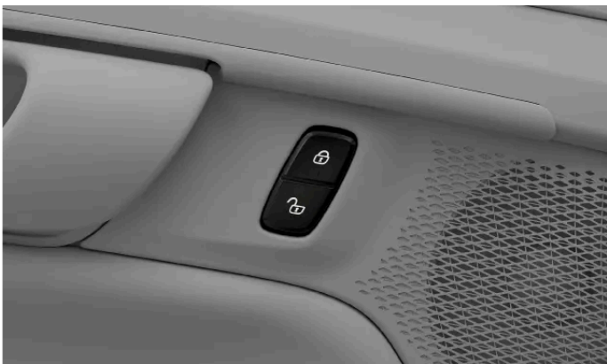
Zentralverriegelungstaste an der Vordertür
