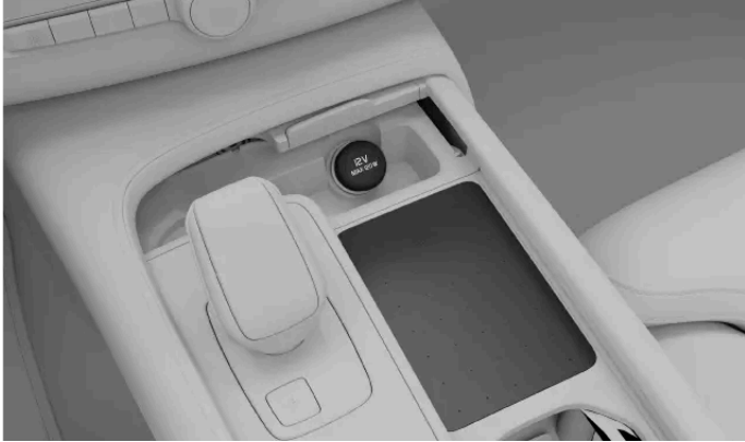
Die 12-V-Steckdose in der Tunnelkonsole
