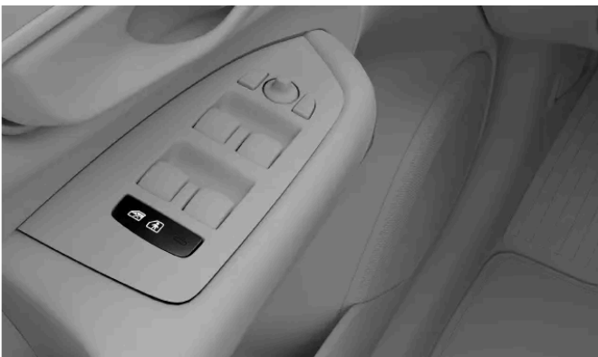
Position der Kindersicherungstaste in der Türverkleidung
