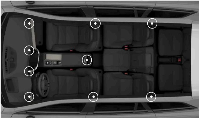
Lage der verstellbaren Lüftungsdüsen
