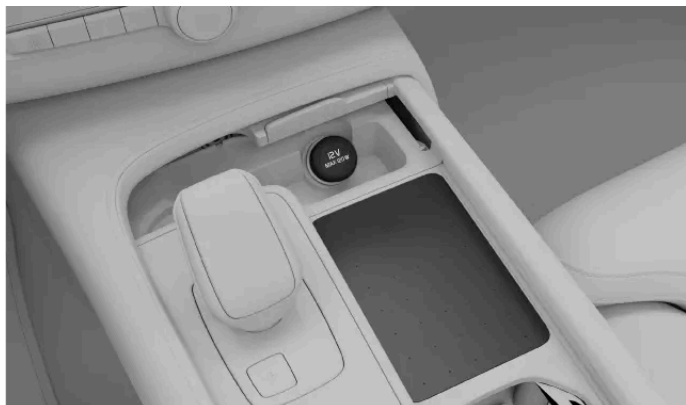
Die 12-V-Steckdose in der Tunnelkonsole
