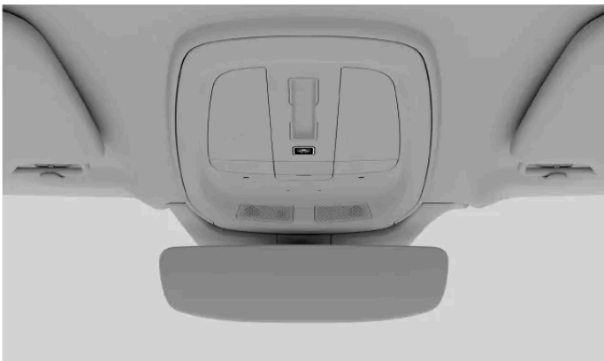
Taste für die volle Innenbeleuchtung an der Deckenkonsole
