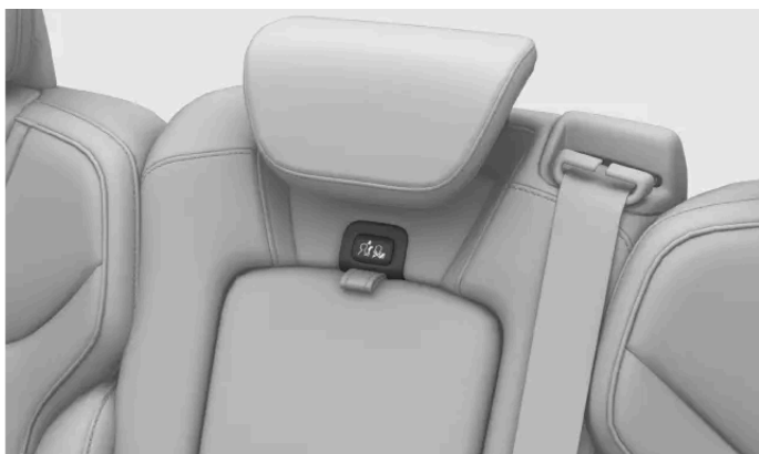
Verriegelungstaste an der mittleren Kopfstütze
