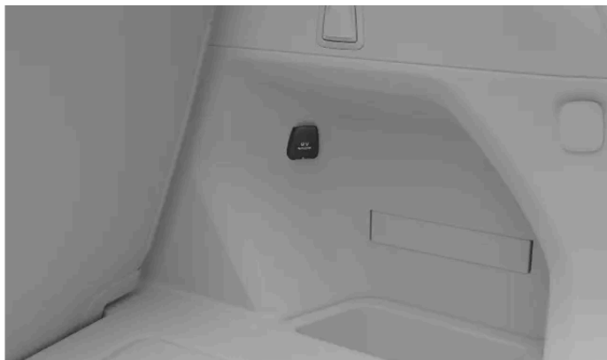
Die 12-V-Steckdose an der rechten Kofferraumwand
