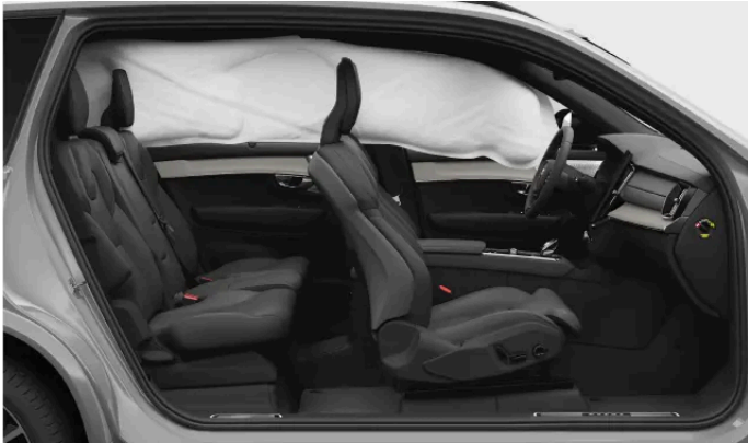
Auf einer Seite des Fahrzeugs ausgelöster Kopf-/Schulterairbag.
