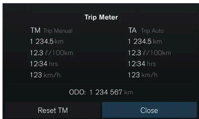
Ihr Fahrzeug verfügt über einen Tageskilometerzähler und einen Kilometerzähler. Der Tageskilometerzähler kann Informationen über die Fahrstrecke und die Fahrzeit sowie über den durchschnittlichen Kraftstoffverbrauch und die Fahrgeschwindigkeit anzeigen.
