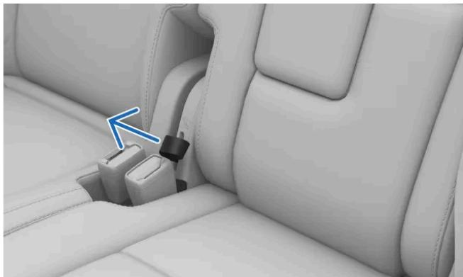
Ziehen Sie an der Schlaufe, die sich seitlich am Sitzpolster befindet, um die Rückenlehne zu entsperren.
