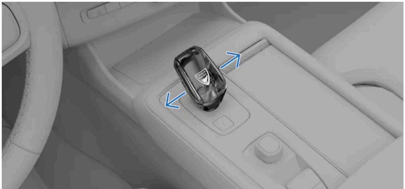
Nachdem Sie die Getriebestellung M ausgewählt haben, können Sie die Gänge manuell schalten, indem Sie den Wählhebel nach links oder rechts bewegen.
