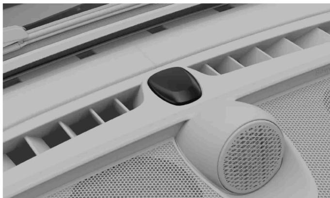
Die Alarmanzeige ist eine Leuchte in der Mitte des Armaturenbretts, direkt vor der Windschutzscheibe. Die Anzeige bestätigt die Aktivierung der Alarmanlage, indem sie rot blinkt.
