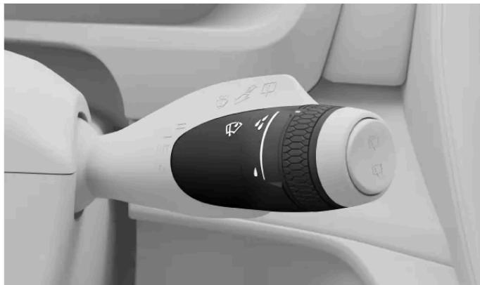
Die Bedienelemente des Frontscheibenwischers befinden sich am rechten Lenkradhebel.
