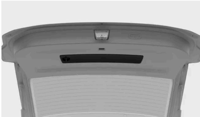
Das Warndreieck befindet sich in einem Fach innen am Kofferraumdeckel. Öffnen Sie das Fach, indem Sie den Griff in die senkrechte Stellung drehen und dann an ihm ziehen.
