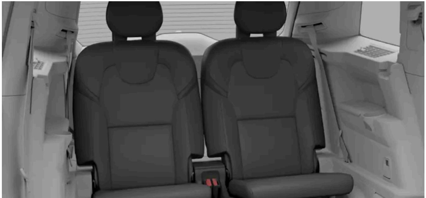
Für mehr Stauraum lassen sich Rückenlehne und Kopfstütze in einer Bewegung umklappen. Die Kopfstütze klappt beim Neigen der Rückenlehne automatisch nach unten.
