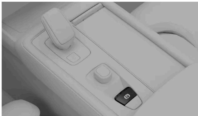
Aktivieren Sie die Feststellbremse manuell, indem Sie den Schalter der Feststellbremse ziehen.
