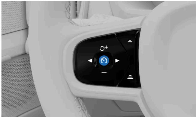
Wenn dies sicher möglich ist: Drücken Sie die Lenkradtaste für Pilot Assist
