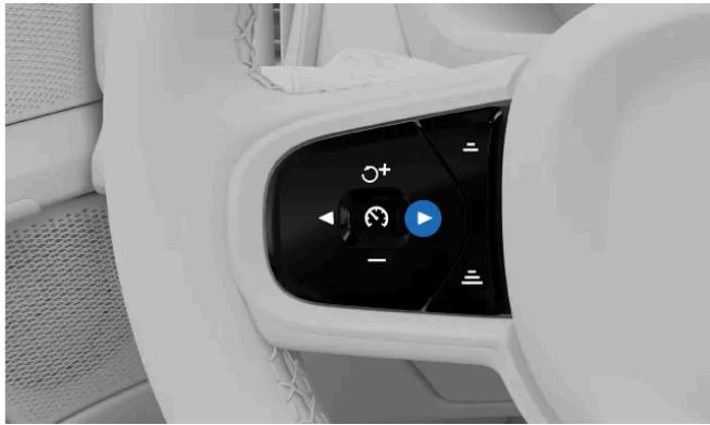
Drücken Sie die Umschalttaste ► am Lenkrad.
