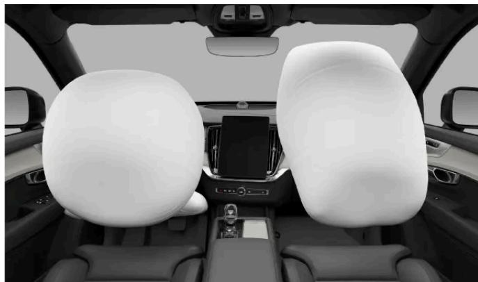
Auf der Fahrerseite befinden sich zwei Frontairbags. Der obere Airbag ist im Lenkrad untergebracht; der Knieairbag hinter einem Verkleidungselement der Lenksäule.
