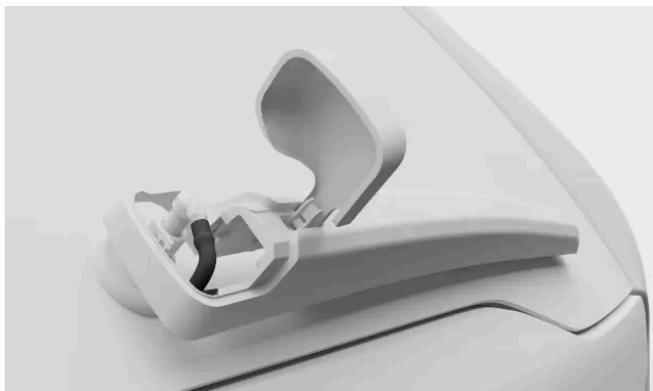
Finden Sie die Kunststoffabdeckung an der Montagestelle des Scheibenwischers am Fahrzeug. Lösen Sie diese Abdeckung zuerst an der Seite, die Ihnen am nächsten liegt, und dann an der Seite, die am weitesten von Ihnen entfernt ist. Heben Sie die Kunststoffabdeckung ganz ab. Dadurch bekommen Sie Zugang zum Schlauchanschluss.
