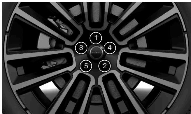
Ziehen Sie die Radmuttern oder -schrauben über Kreuz an.
