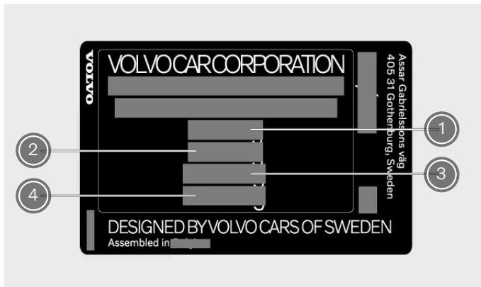
Der Aufkleber befindet sich an der rechten Türsäule und ist bei geöffneter Tür sichtbar.
