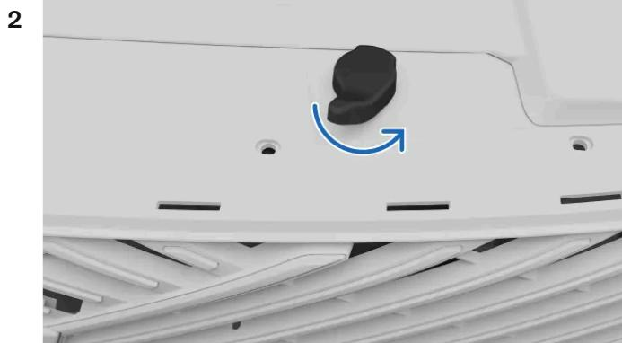
Suchen Sie den zweiten Hebel unter der Vorderkante der Frontklappe und drehen Sie ihn gegen den Uhrzeigersinn.
