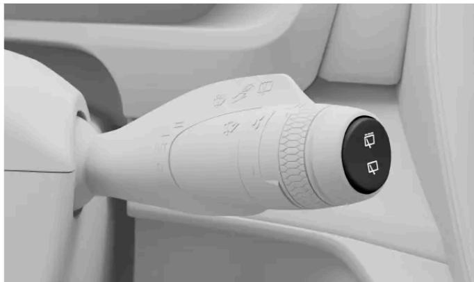
Die Bedienelemente für den Heckscheibenwischer befinden sich am rechten Lenkradhebel.
