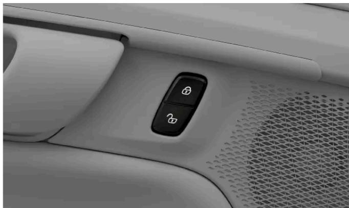
Zentralverriegelungstaste an der Vordertür
