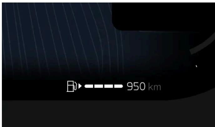
Ihre Reichweite ist in erster Linie von der verbleibenden Kraftstoffmenge in Ihrem Fahrzeugtank und Ihrer Fahrweise abhängig, wird aber auch durch externe Faktoren beeinflusst. Die Tankanzeige und die berechnete Reichweite werden auf dem Fahrerdisplay angezeigt.
