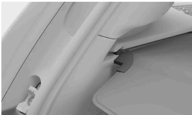
Führen Sie die Enden der Laderraumabdeckung in den Rillen in die eingerastete Position.
