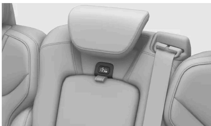
Verriegelungstaste an der mittleren Kopfstütze
