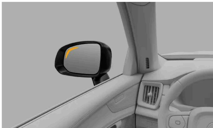
Wenn erkannt wird, dass sich ein Fahrzeug in Ihrem toten Winkel befindet oder sich diesem nähert, schaltet sich ein Licht am Außenspiegel ein.
