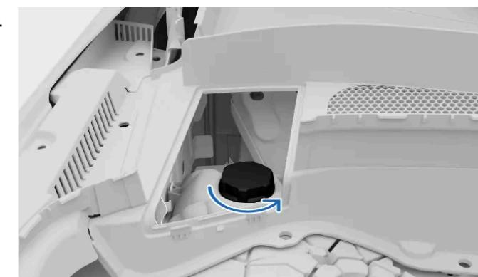
Schrauben Sie den Deckel des Kühlmittelbehälters ab.
