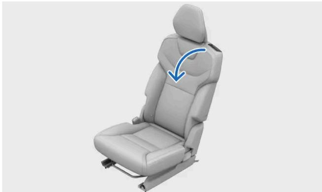
Ziehen Sie dafür am Griff, der sich oben an der Rückenlehne des äußeren Sitzes befindet.
