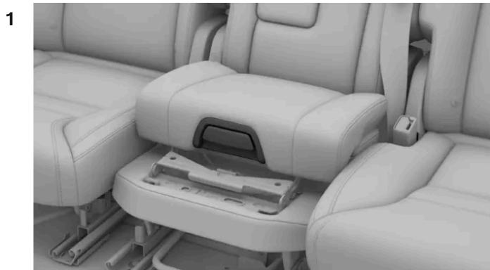
Ziehen Sie am Griff, der sich vorn an der Sitzerhöhung befindet, um die Arretierung aufzuheben.
