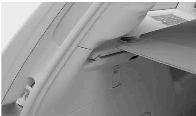
Heben Sie die Laderraumabdeckung an und führen Sie sie an beiden Seiten aus der abgeknickten Nut. Halten Sie den Griff fest und führen Sie die Laderraumabdeckung aus den oberen Nuten heraus. Nun kann die Abdeckung automatisch eingezogen werden.
