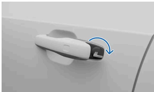
**5** Drehen Sie den Schlüssel um 45 Grad gegen den Uhrzeigersinn wieder zurück in seine Ausgangsposition und ziehen Sie ihn ab.
