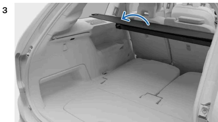
Ziehen Sie die Laderraumabdeckung am Griff über die Seitenwände des Kofferraums.
