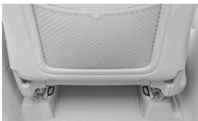
Die unteren Verankerungspunkte befinden sich hinten an den Bodenschienen der Vordersitze.
