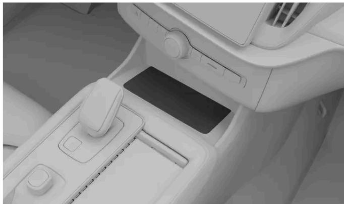
Um ein Gerät auf der kabellosen Ladeablage aufladen zu können, muss dieses für das kabellose Laden gemäß Qi-Standard zertifiziert sein. Außerdem muss das kabellose Laden sowohl am Gerät<sup>[1]</sup> als auch an der Ladeablage aktiviert sein. Die Ladeablage aktivieren Sie über das Center Display.
