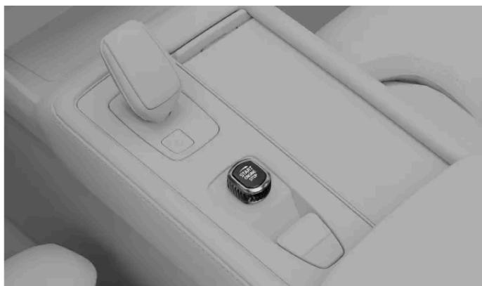
Drehen Sie den Startknopf im Uhrzeigersinn, um das Fahrzeug auszuschalten.
