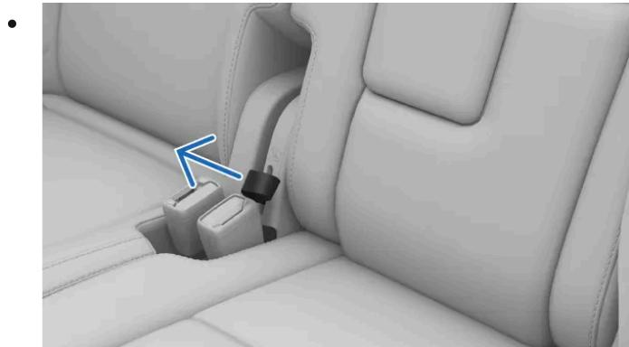
Ziehen Sie an der Schlaufe, die sich seitlich am Sitz befindet.
