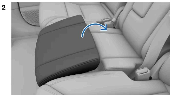
Halten Sie die Sitzerrhöhung mit einer Hand vorn und einer Hand hinten fest und schieben Sie sie nach oben und ganz an die Rückenlehne des Sitzes.
