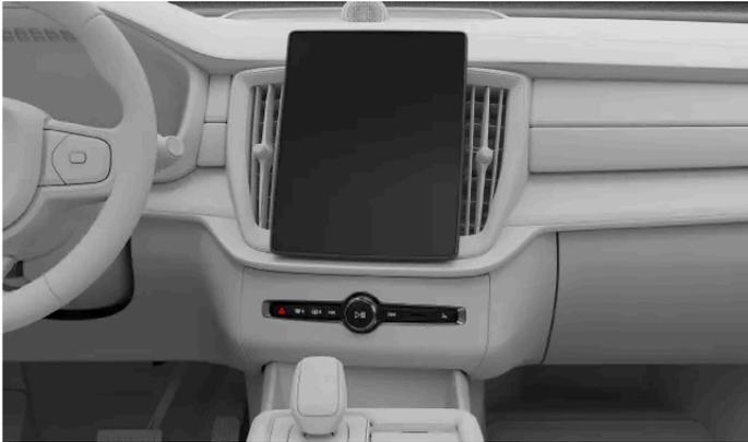
Center Display und Enteisungstasten am Bedienfeld unter dem Center Display
