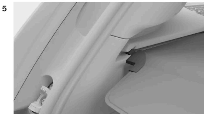
Führen Sie die Enden der Laderaumabdeckung in den Rillen in die eingerastete Position.
