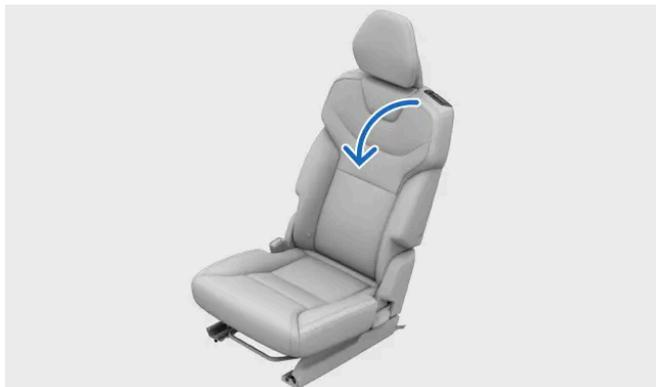
Ziehen Sie dafür am Griff, der sich oben an der Rückenlehne des äußeren Sitzes befindet.
