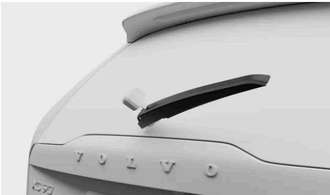
Ergreifen Sie den Wischerarm in der Mitte und heben Sie ihn von der Heckscheibe ab. Auf halbem Weg nehmen Sie ggf. einen gewissen Widerstand wahr – dies ist die Sperrstellung. Damit der Wischerarm nicht zurück auf die Scheibe fällt, müssen Sie ihn über diese Stellung hinaus von der Scheibe abheben.
