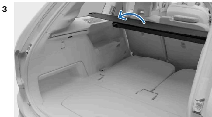
Ziehen Sie die Laderaumabdeckung am Griff über die Seitenwände des Kofferraums.
