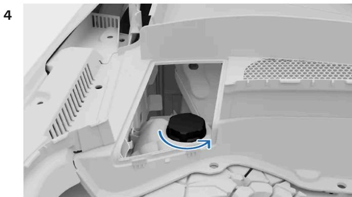
Schrauben Sie den Deckel des Kühlmittelbehälters ab.
