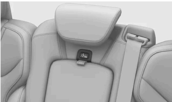
Verriegelungstaste an der mittleren Kopfstütze
