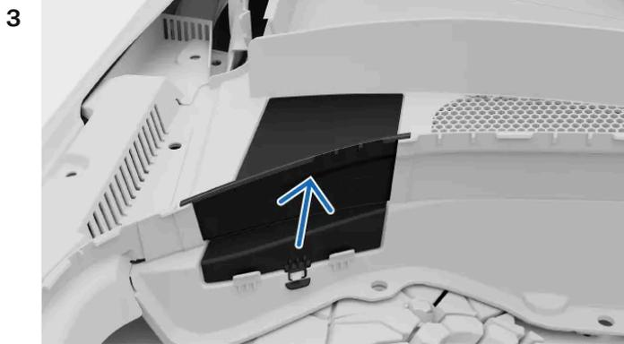
Öffnen Sie die Klappenverriegelung und heben Sie die Klappe nach oben, um sie zu lösen.
