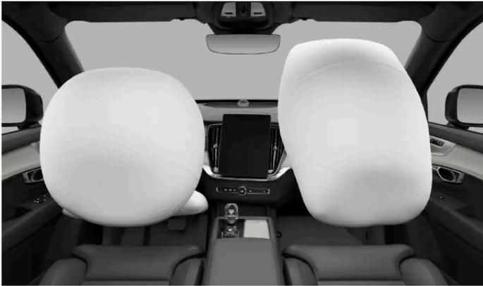
Auf der Fahrerseite befinden sich zwei Frontairbags. Der obere Airbag ist im Lenkrad untergebracht; der Knieairbag hinter einem Verkleidungselement der Lenksäule.
