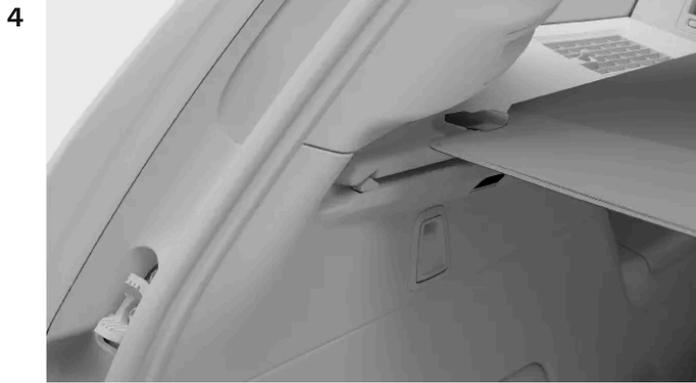
Schieben Sie die Enden der Laderaumabdeckung in die oberen Rillen an den Seitenwänden.
