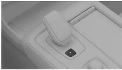
Wenn P ausgewählt ist, wird das Getriebe mechanisch blockiert, um versehentliches Schalten zu vermeiden.
