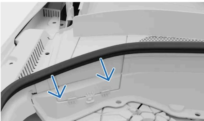
Der Kühlmittelbehälter befindet sich in der linken oberen Ecke des Motorraums unter einer Klappe. Ziehen Sie die Gummidichtung in Richtung Motorraum, um an die Klappe zu gelangen.
