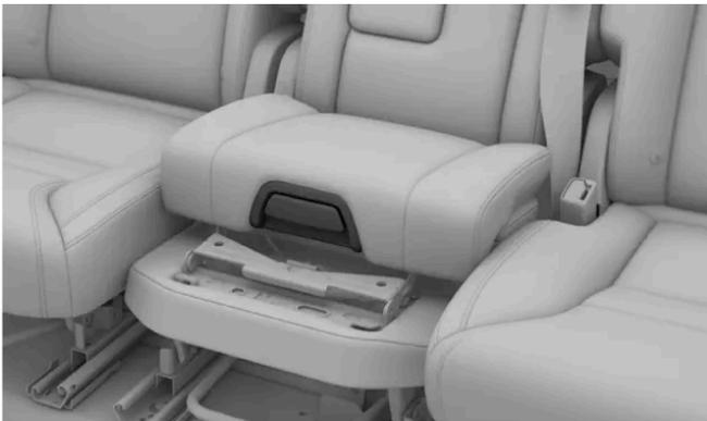
Ziehen Sie am Griff, der sich vorn an der Sitzerrhöhung befindet, um die Arretierung aufzuheben.
