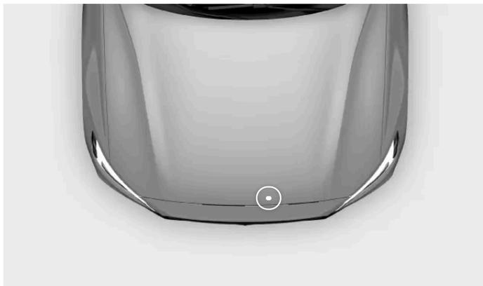
Der zweite Hebel befindet sich auf Fahrerseite unter der Vorderkante der Frontklappe.
