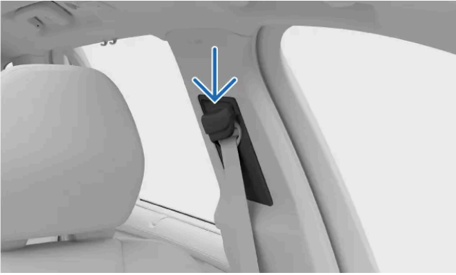
Oberer Verankerungspunkt des Sicherheitsgurts.
