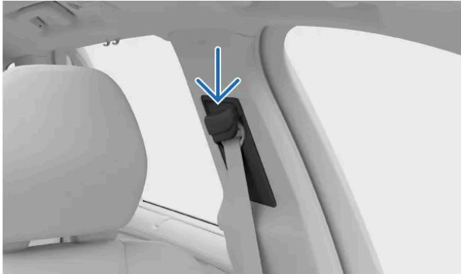
Oberer Verankerungspunkt des Sicherheitsgurts.
