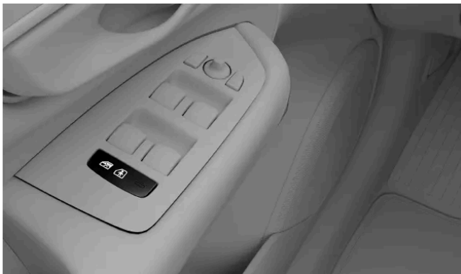
Position der Kindersicherungstaste in der Türverkleidung
