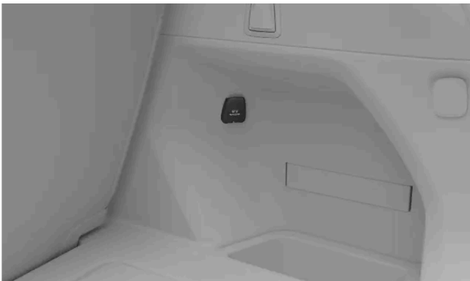
Die 12-V-Steckdose an der rechten Kofferraumwand
