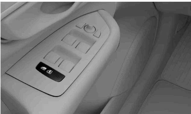
Position der Kindersicherungstaste in der Türverkleidung
