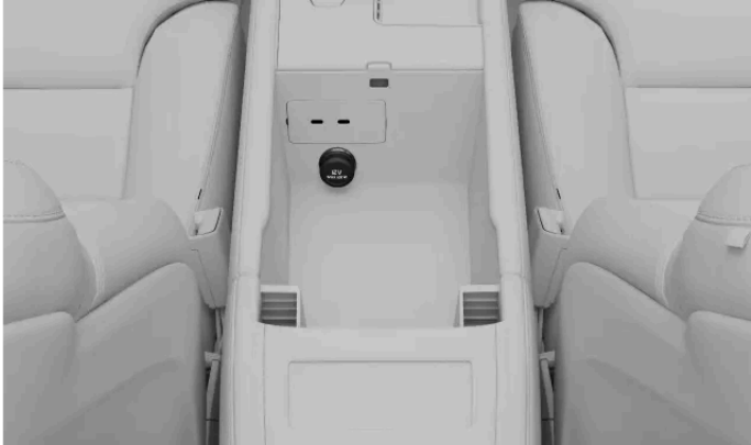
Die 12-V-Steckdose in der Tunnelkonsole
