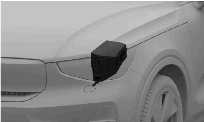
Placering af sikringsskab
