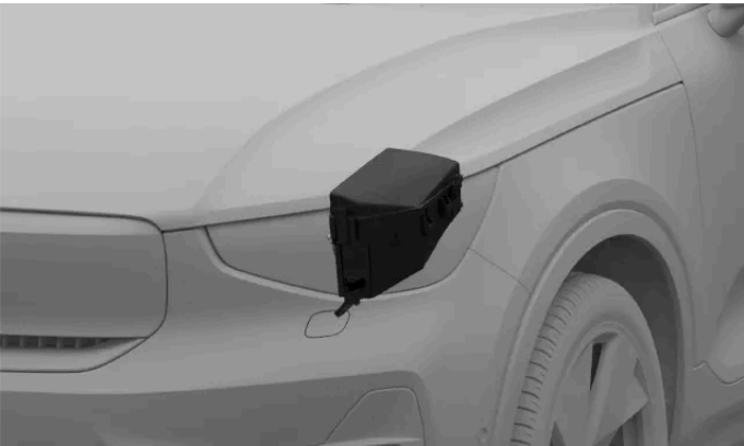
Placering af sikringsskab
