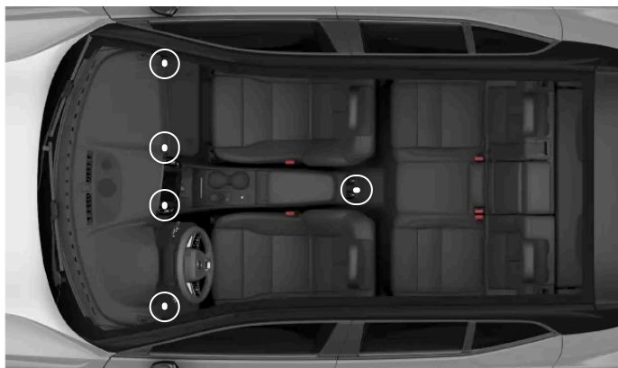
De justerbare luftdysers placering
