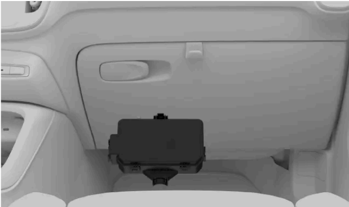
Placering af sikringsskab
