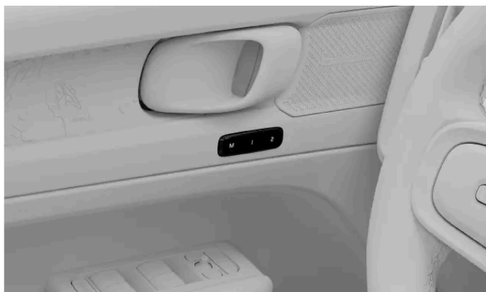
Placering af knapperne til forudindstillinger af sædet
