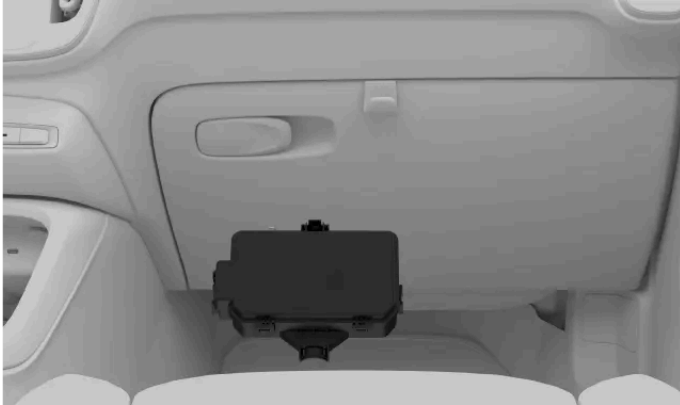
Placering af sikringssskab
