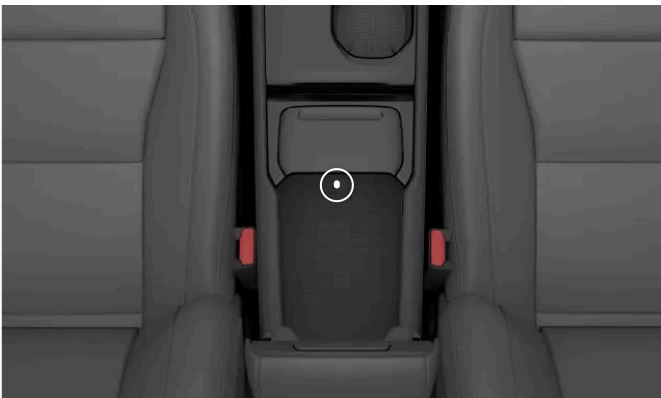
Placering af backup-læseren i tunnelkonsollens opbevaringsrum
