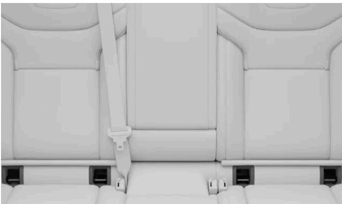
Placeringer af ISOFIX-forankringspunkter til bagsæderne
