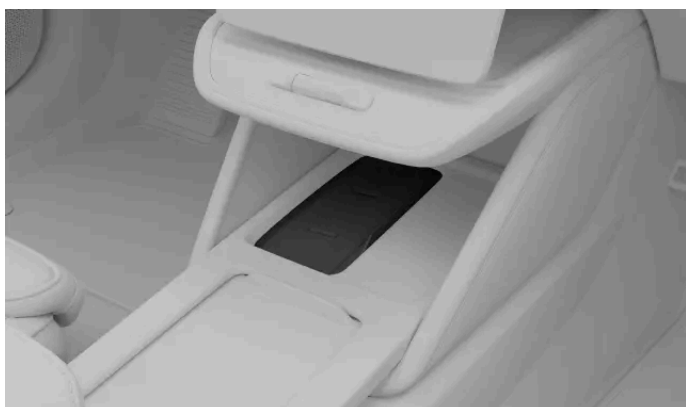
Nøglelæseren mellem forsæderne er også den trådløse oplader.
