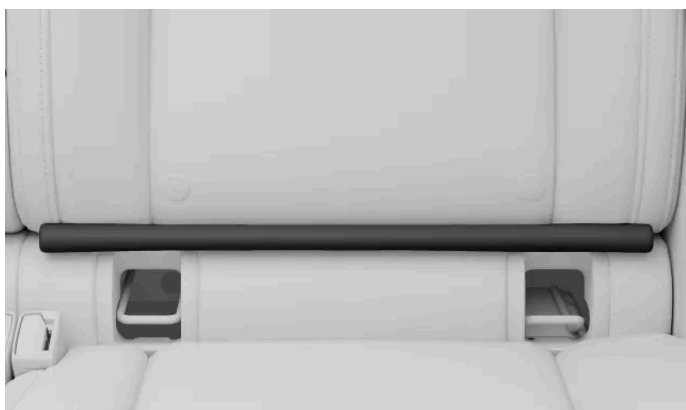
Den foldede ISOFIX-klap, gemt i mellemrummet over forankringspunkterne
