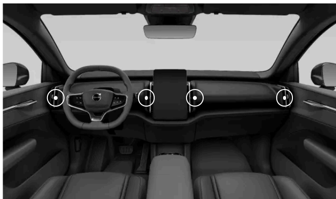
De justerbare luftdysers placering.
