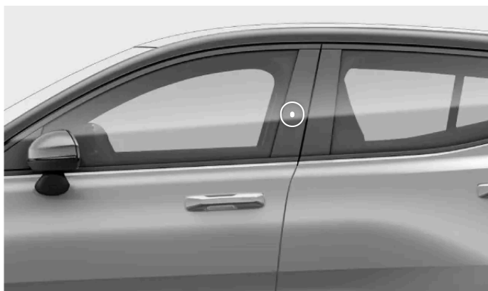
Nøglelæsningsplacering på førerdørstolpen
