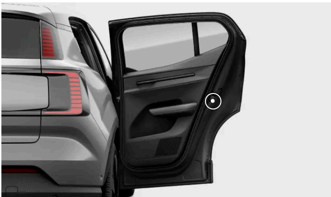
Placering af børnesikringskontakt.
