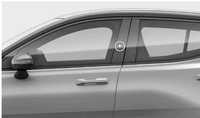
Nøglelæsningsplacering på dørstolpen
