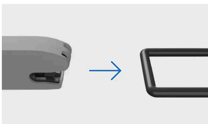
Fastgørelse til ISOFIX-forankringspunkt
