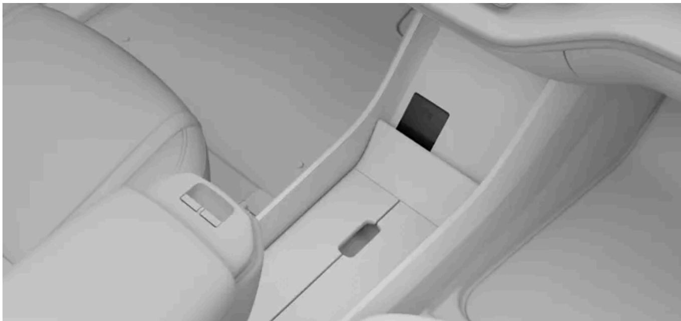
Den trådløse oplader under displayet
