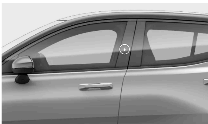
Nøglelæsningsplacering på dørstolpen
