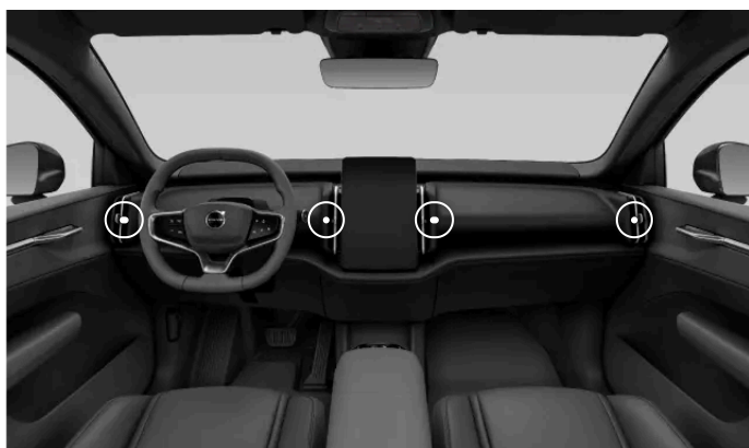
De justerbare luftdysers placering.
