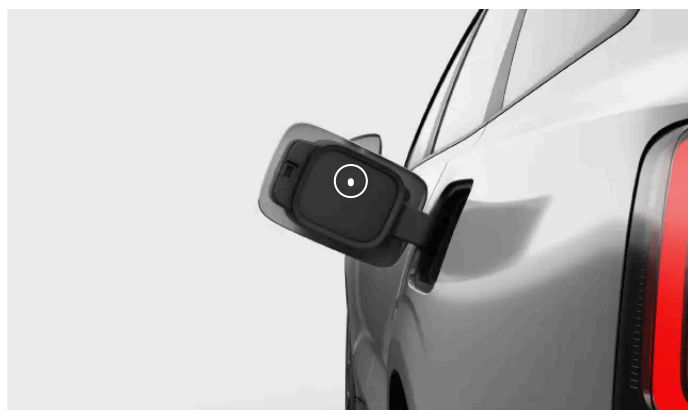
Identifikationsmærkaten sidder på indersiden af opladningslåget.
