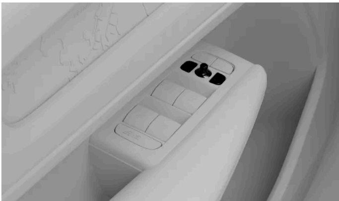
Betjeningselementer til justering af sidespejlene
