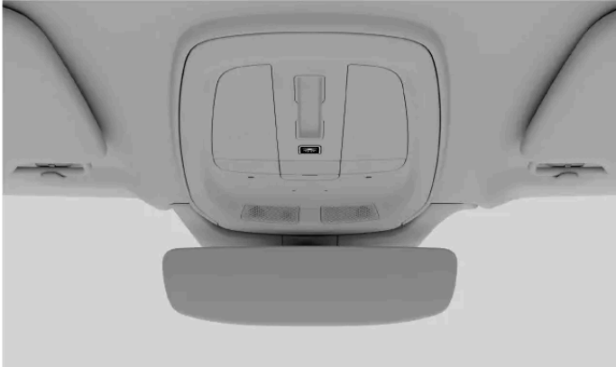
Knappen til slukning af automatisk lys i loftskonsollen
