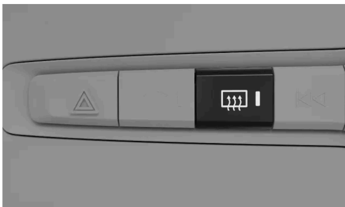
Afrimningsknappen på knappanelet under midterdisplayet
