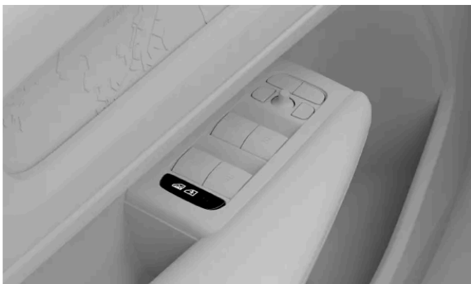
Placering af børnesikringsknappen i dørpanelet
