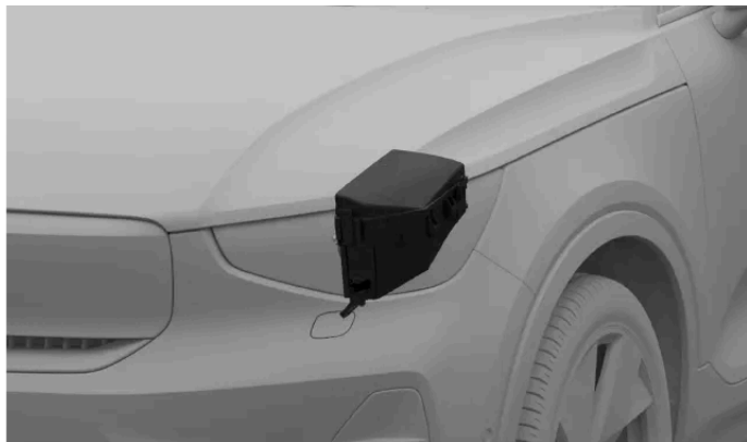
Placering af sikringskab
