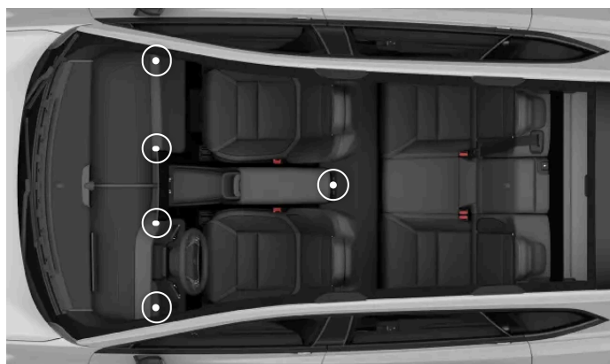
De justerbare ventilationsspjælds positioner i kabinen.
