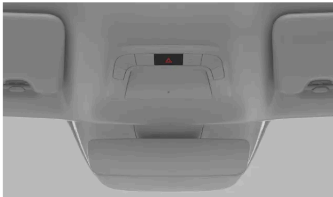
Placeringen af knappen til havariblinket i loftskonsollen
