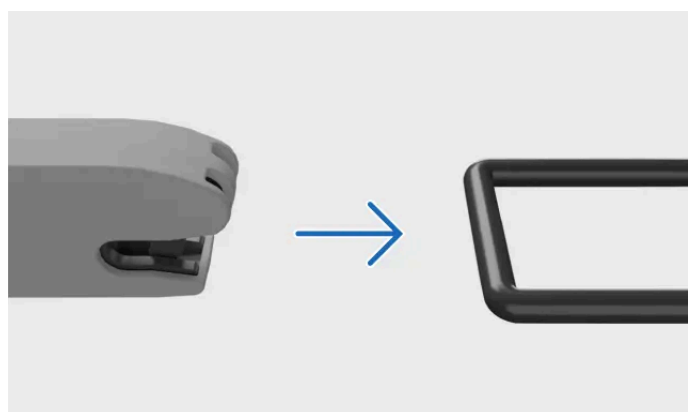
Fastgørelse til ISOFIX-forankringspunkt
