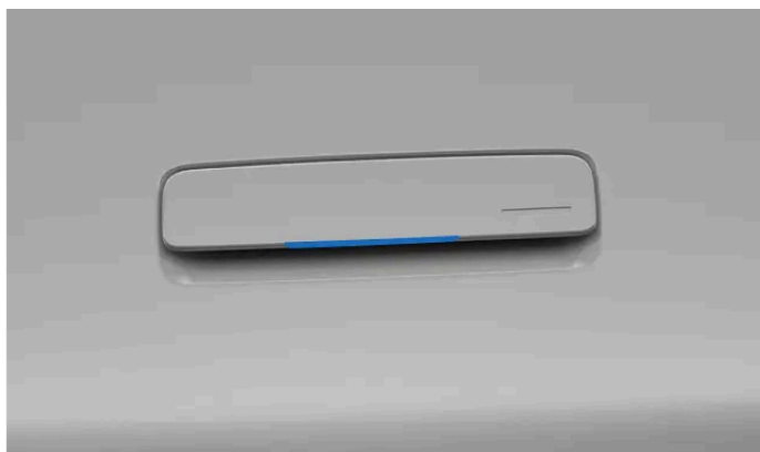
Berøringspunkt på undersiden af dørhåndtaget.
