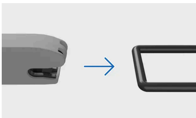
Fastgørelse til ISOFIX-forankringspunkt
