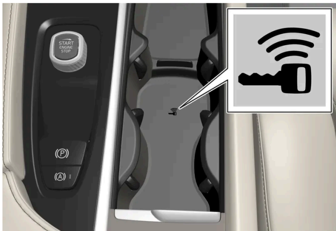
Backup-læserens placering i tunnelkonsollen.
