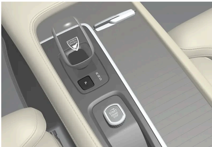
Oversigt over gearstang og position P.
