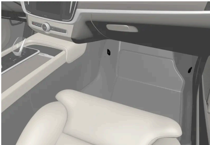
Befæstelsespunkternes placering på forsædet.
