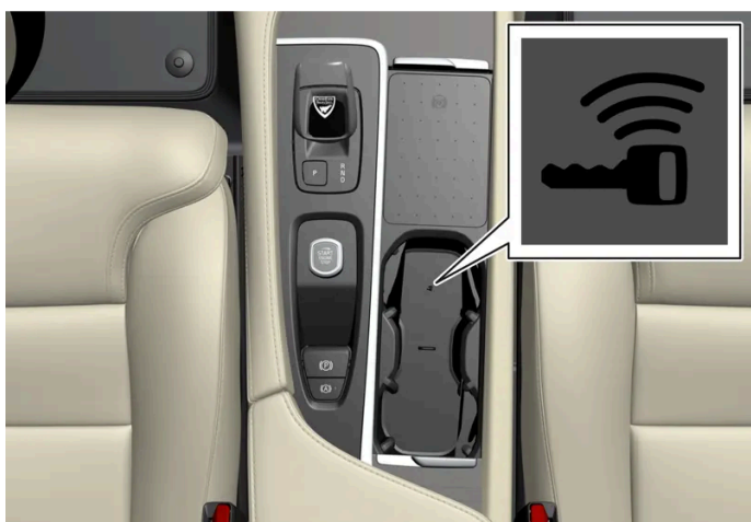
Backup-læserens placering i tunnelkonsollen.
