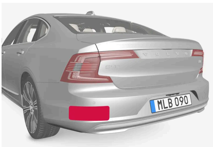
Placering af bageste radarenheder
