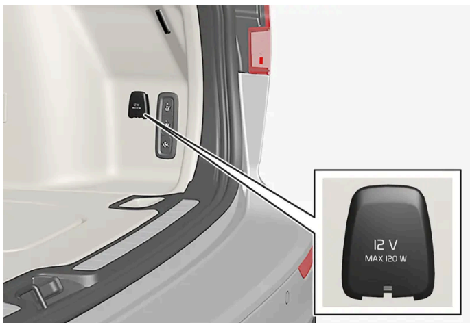
12 V-elkontakt i bagage-/lastrum*.
