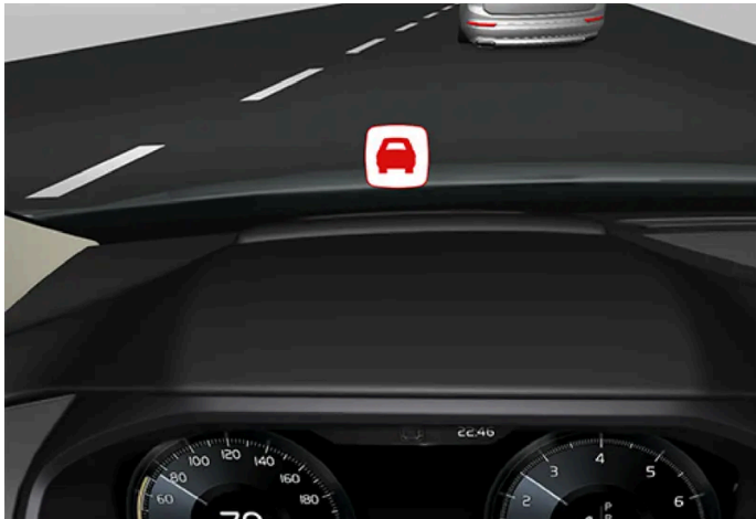
Symbol på forruden for kollisionsfare
