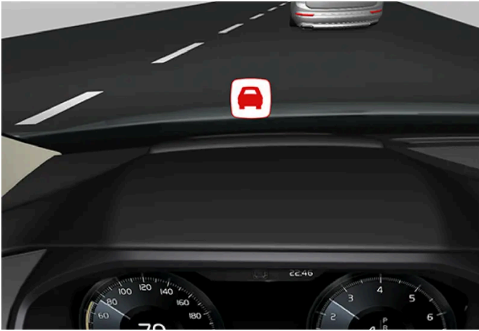
Symbol på forruden for kollisionsfare
