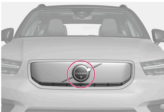
Placering af forreste radarenhed
