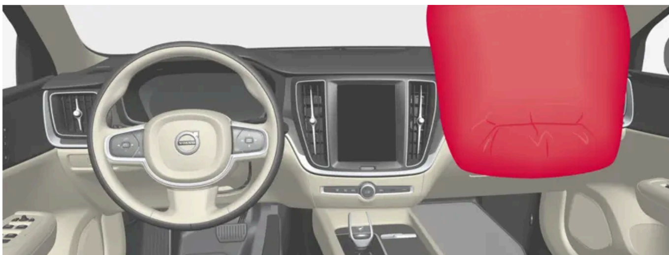
Airbag til forsædet i passagersiden
